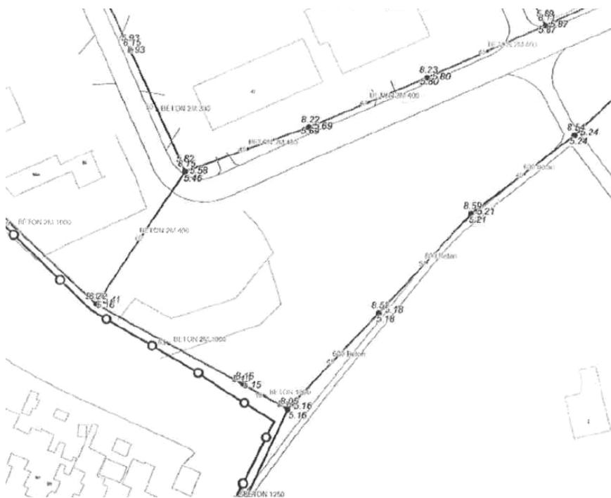
De hoofdrioolpersleiding en overige riolering in en in de omgeving van het plangebied
