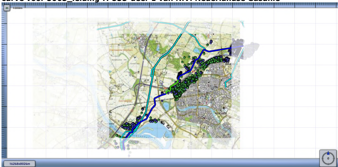
Figuur 4.4 Kilometer leiding behorende bij de maximale overschrijding van de FN-curve voor 5063_leiding-A-533-deel-1 van N.V. Nederlandse Gasunie
