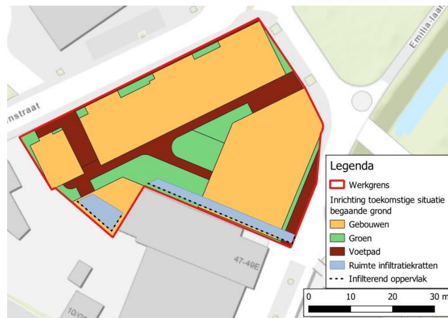
Figuur 4-1: Schetsontwerp beschikbare ruimte infiltratiekratten
