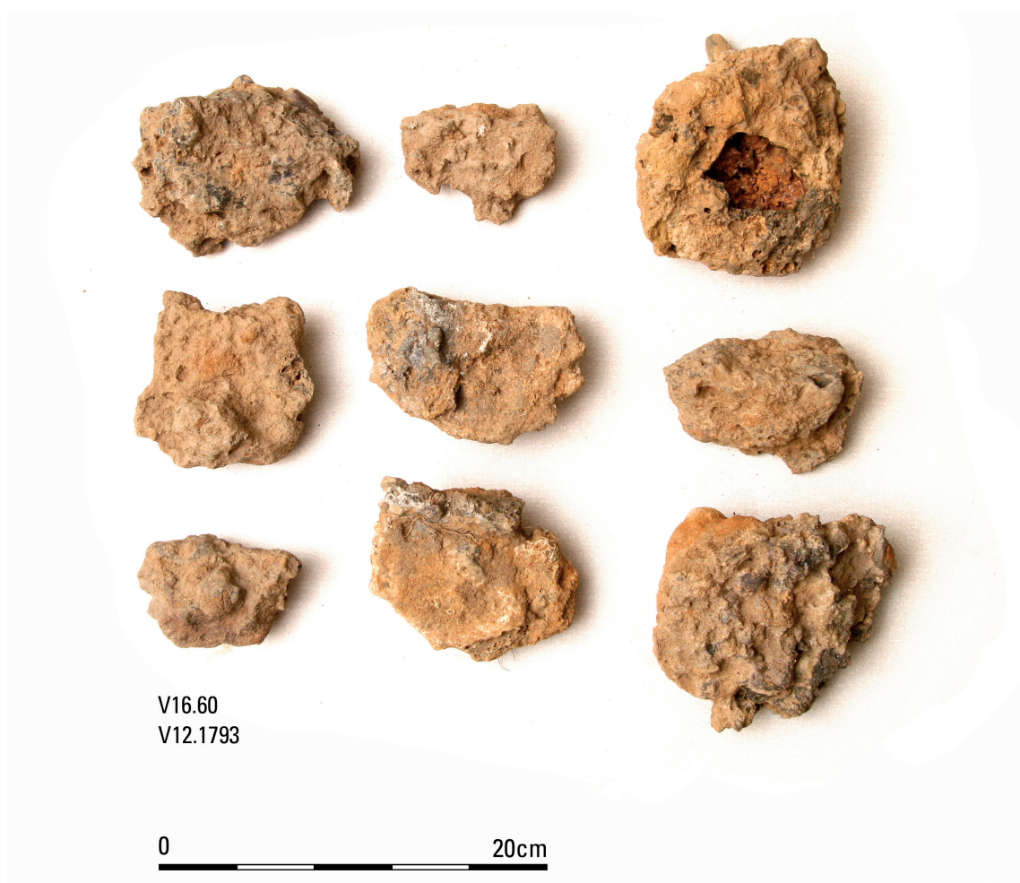
Fig. 11.9. Wijchen-Oostflank. Overzicht van negen complete smeedhaardslakken uit waterput 7005.
