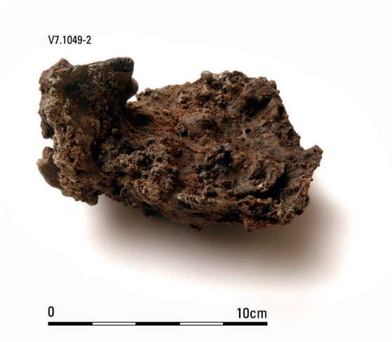
Fig. 11.2. Wijchen-Oostflank. Bodem van productieslak V7.1049-2 uit oven 27000.
