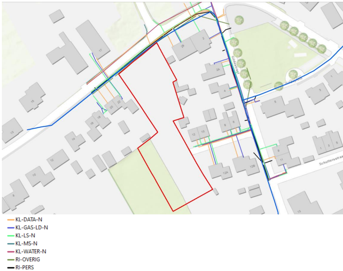
Figuur 2.1 Bestaande kabels en leidingen
