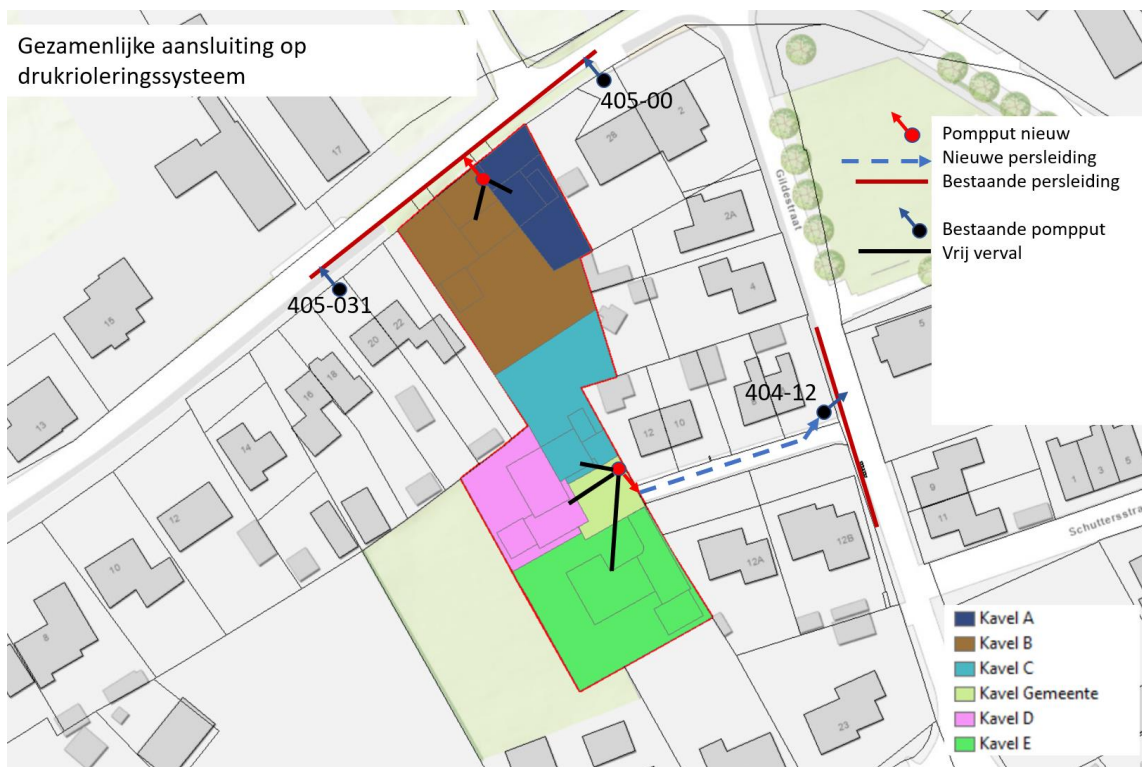
Figuur 6.2 Schetsmatige weergave aansluiting kavels met gezamenlijke rioolgemaal met persleiding
