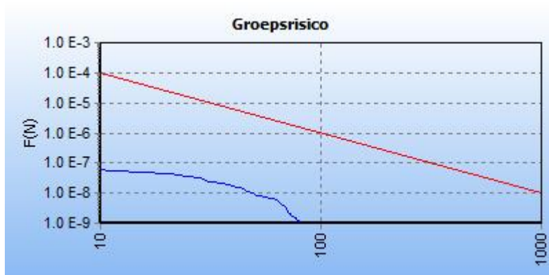
5.5 Figuur 5.5 FN curve voor 9093_leiding-A-525-deel-1 van N.V. Nederlandse Gasunie voor de kilometer tussen stationing 0.00 en stationing 1000.00
