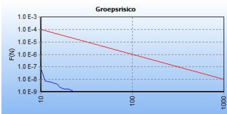
5.2 Figuur 5.2 FN curve voor 9093_leiding-A-507-deel-1 van N.V. Nederlandse Gasunie voor de kilometer tussen stationing 2850.00 en stationing 3850.00
