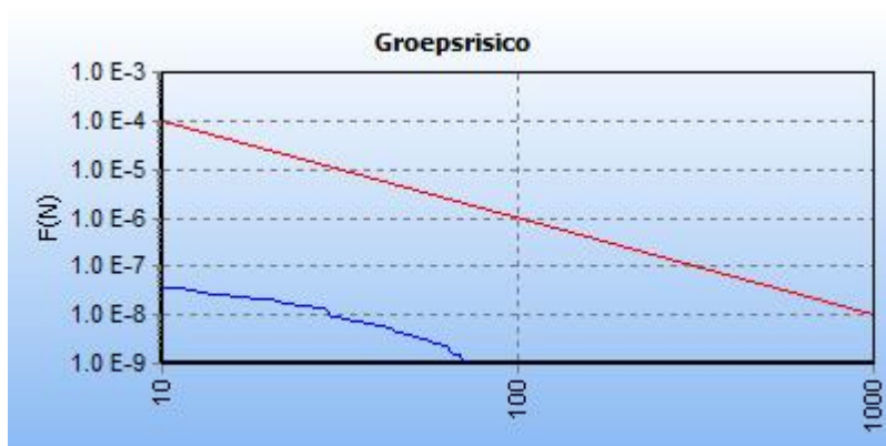
5.14 Figuur 5.14 FN curve voor 9093_leiding-A-674-deel-1 van N.V. Nederlandse Gasunie voor de kilometer tussen stationing 2710.00 en stationing 3710.00
