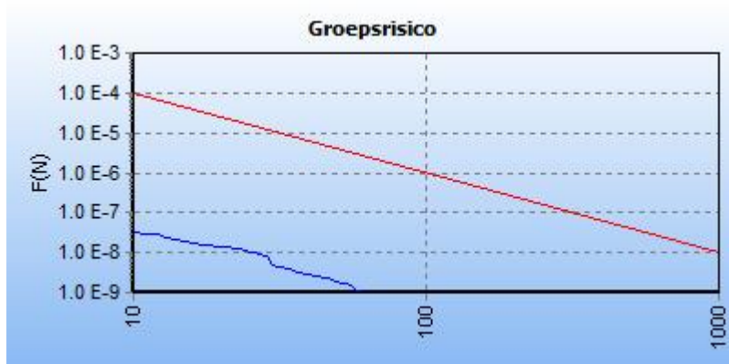
5.13 Figuur 5.13 FN curve voor 9093_leiding-A-665-deel-1 van N.V. Nederlandse Gasunie voor de kilometer tussen stationing 0.00 en stationing 1000.00
