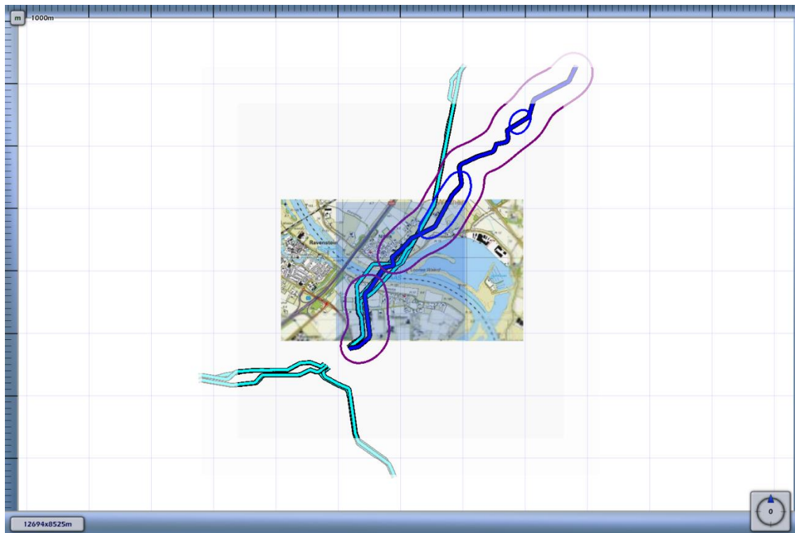
3.9 Figuur 3.9 Plaatsgebonden risico voor 9093_leiding-A-578-deel-1 van N.V. Nederlandse Gasunie
