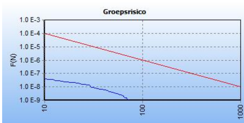
5.14 Figuur 5.14 FN curve voor 9093_leiding-A-674-deel-1 van N.V. Nederlandse Gasunie voor de kilometer tussen stationing 2620.00 en stationing 3620.00
