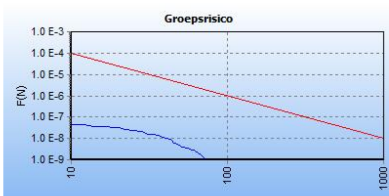
5.8 Figuur 5.8 FN curve voor 9093_leiding-A-533-deel-1 van N.V. Nederlandse Gasunie voor de kilometer tussen stationing 3700.00 en stationing 4700.00
