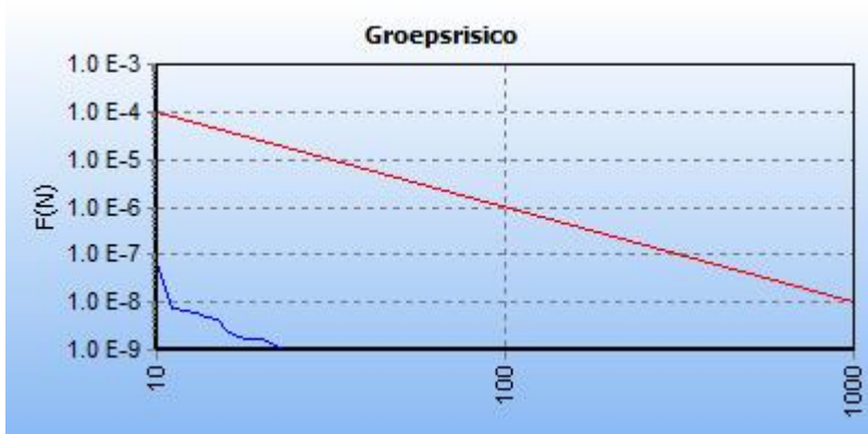
5.2 Figuur 5.2 FN curve voor 9093_leiding-A-507-deel-1 van N.V. Nederlandse Gasunie voor de kilometer tussen stationing 3220.00 en stationing 4220.00
