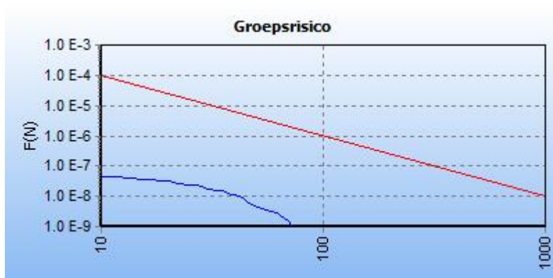
5.8 Figuur 5.8 FN curve voor 9093_leiding-A-533-deel-1 van N.V. Nederlandse Gasunie voor de kilometer tussen stationing 3960.00 en stationing 4960.00
