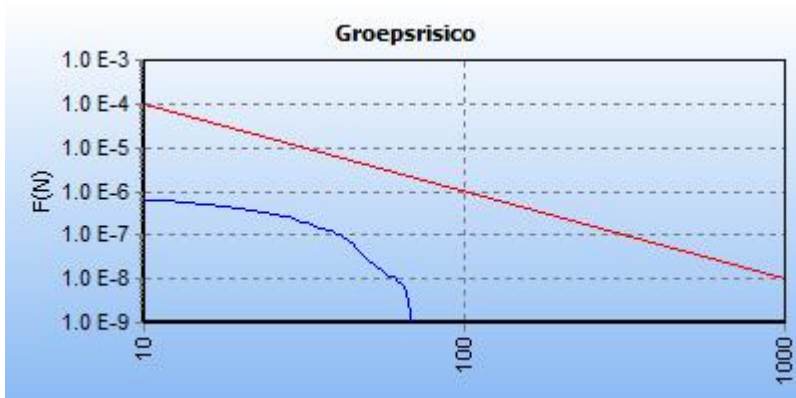
5.2 Figuur 5.2 FN curve voor 9093_leiding-A-507-deel-1 van N.V. Nederlandse Gasunie voor de kilometer tussen stationing 2850.00 en stationing 3850.00
