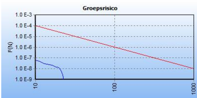
5.2 Figuur 5.2 FN curve voor 9093_leiding-A-507-deel-1 van N.V. Nederlandse Gasunie voor de kilometer tussen stationing 3220.00 en stationing 4220.00
