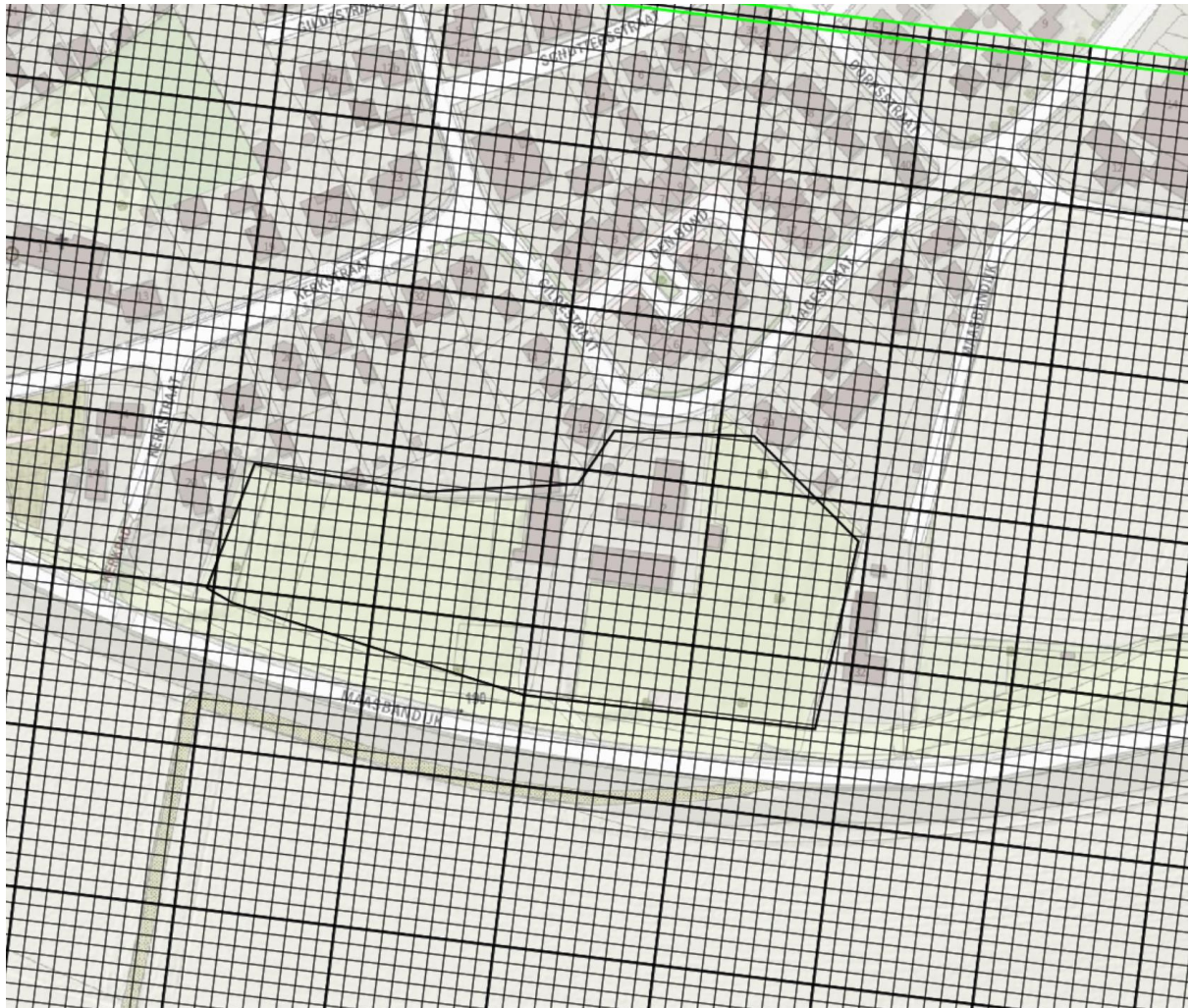
Figuur 7-4 Gebied dat wordt opgehoogd tot +8 à +9,3 m NAP met zand met een k-waarde van 2 m/dag
