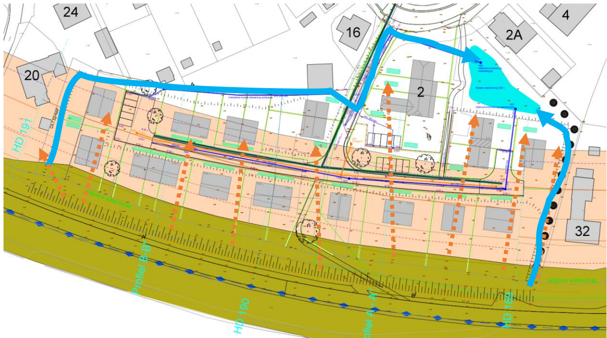
Figuur 7-2 Principeschets drain ter voorkoming van horizontale kwelstromen vanuit het plan naar de omgeving
