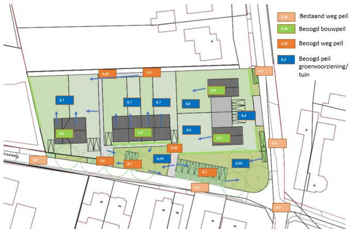
Afbeelding 19 Afstroomrichting voor het hemelwater
