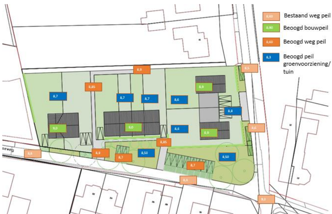
Afbeelding 18 Voorstel bouwpeilen en wegpeilen
