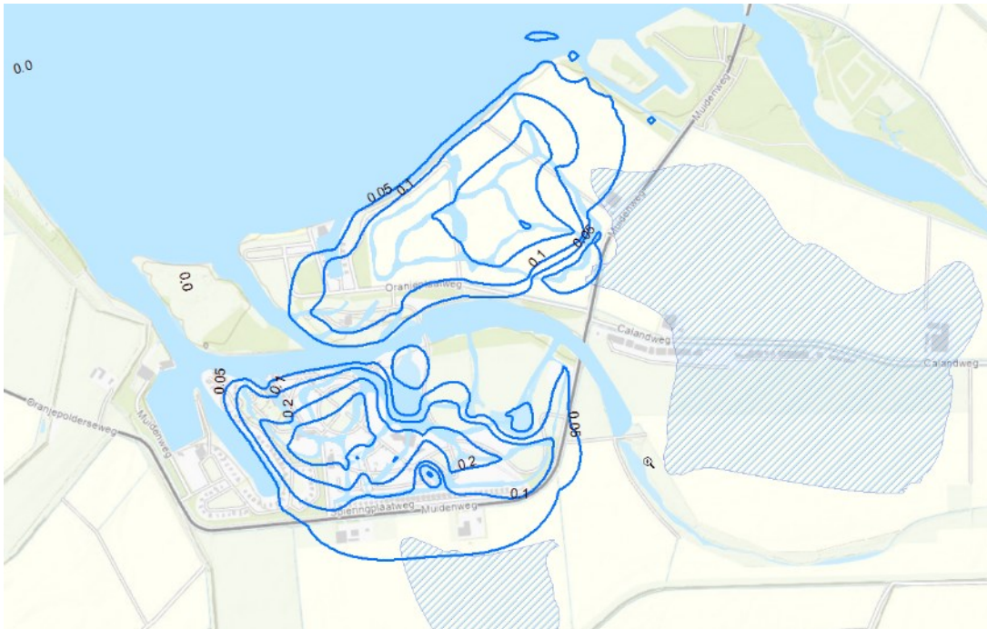
Figuur 4.3 Invloed aanleg oppervlaktewatersysteem met bodemweerstand 10 dagen (zoetwatervoorkomens zijn gearceerd)
