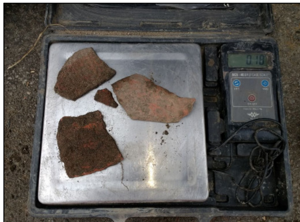
Foto 37: Deellocatie 1C, 057, asbestplaat
