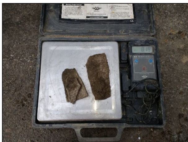
Foto 36: Deellocatie 1C, 057, asbestgolfplaat
