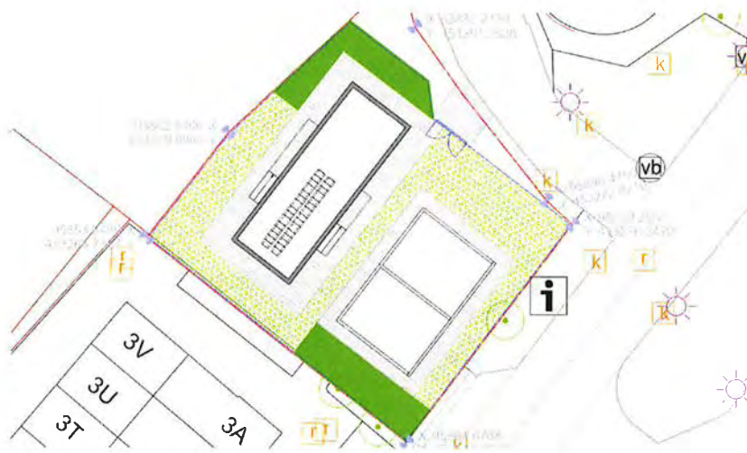
Afbeelding 4.1 Beoogde indeling transformatorstation
