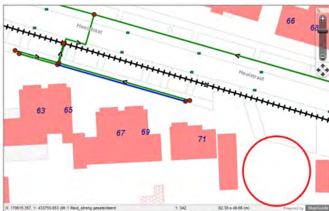
Figuur: beoogde situatie m.b.t. afvoer hemelwater en vuil water
