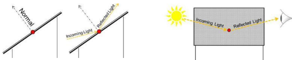
Afbeelding 23. Reflectie van zonlicht, waarbij de inkomende hoek gelijk is aan de uitgaande hoek.
