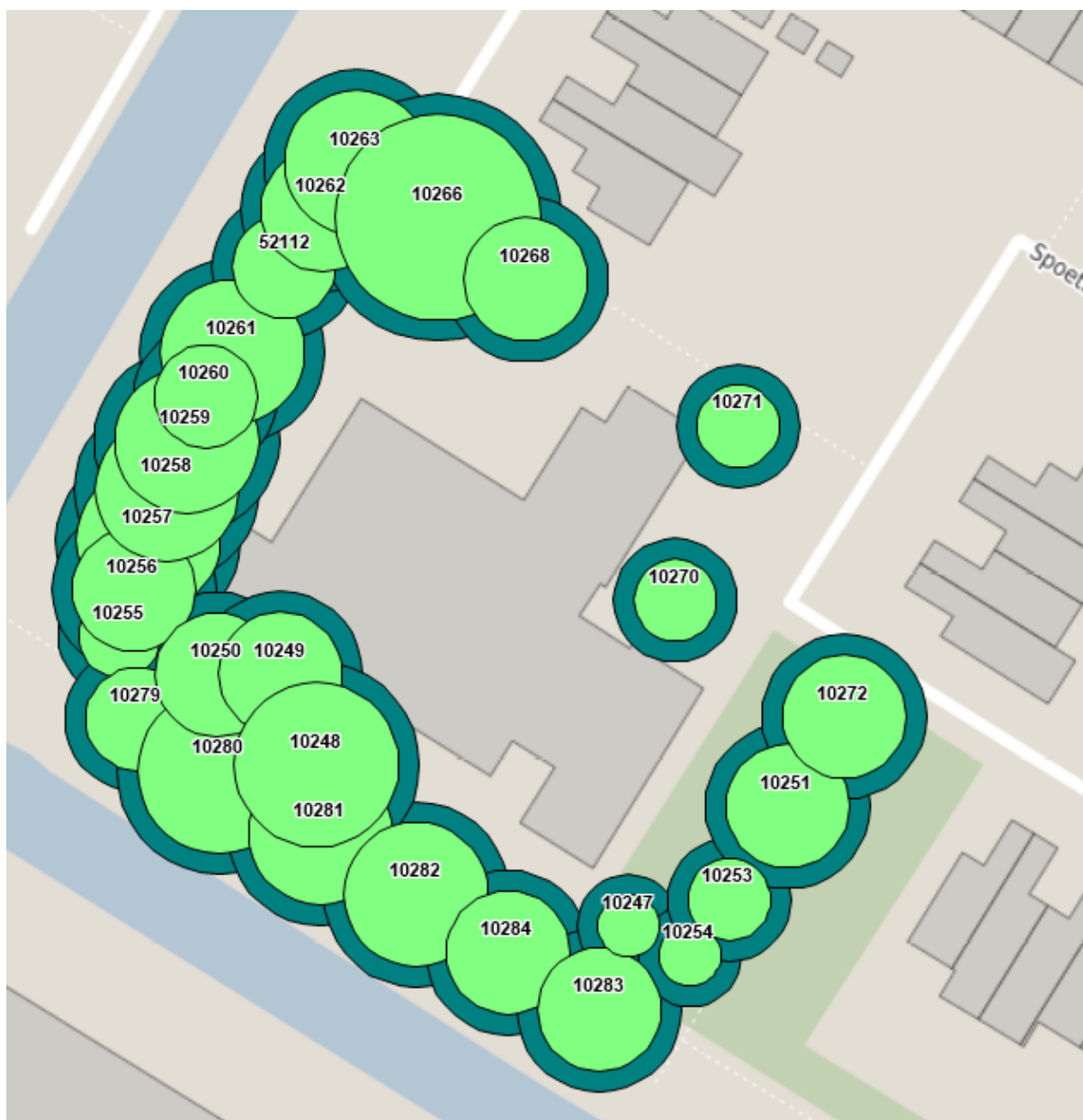
Overzicht kroondiameter + 2 meter kwetsbare zone Hitteschild 4
