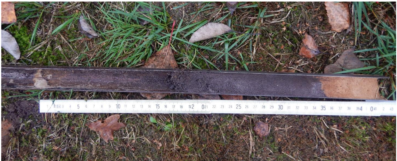
Afbeelding 8. Boorkern (boring 2) met de bouwvoor van 0 tot 35 cm met daaronder na een scherpe grens het gele dekzand (C-horizont).
