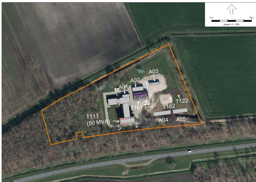
f 2.3 Globale lay-out transformatorstation Gasselternijveen (fase 1)
