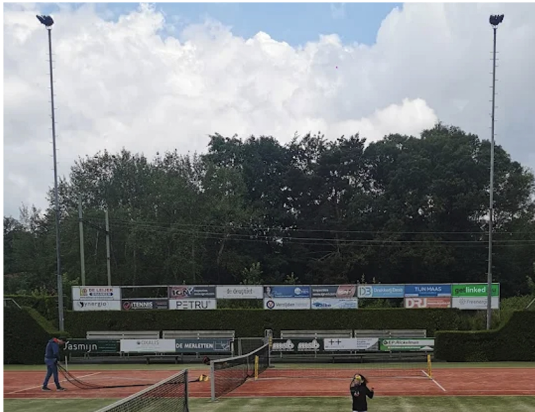
Figuur 11 Triple-A Lux armaturen met kantel 40 - 45 graden op tennisvelden
