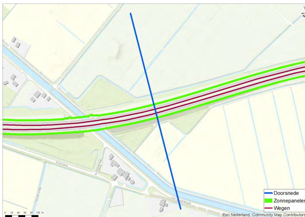
Afbeelding 6.3 Situatie waarin enkel aan de buitenzijde zonnepanelen zijn geplaatst ter hoogte van Holsloot
