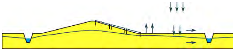
Afbeelding 4.9 Hydrologische kringloop met zonnewand en zonnepaneel op nieuw talud
