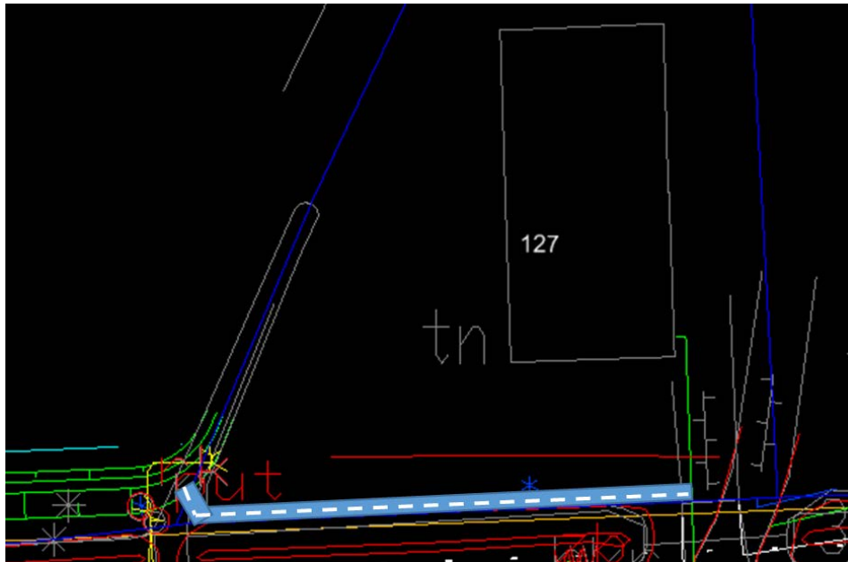
Figuur 3.24 Bermverlaging (lichtblauw) met infiltratieriool/drain (witte onderbroken lijn) bij woningnummer 127
