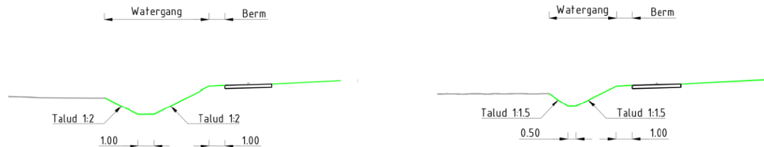
Figuur 2.3 Profiel A-watergang (links) en watergang in beheer bij provincie Gelderland (rechts)
