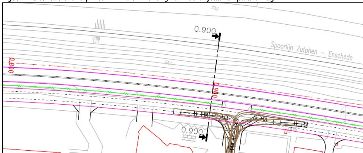
Figuur 2: Uitsnede ontwerp met minimale inrichting van hoofdrijbaan en parallelweg
