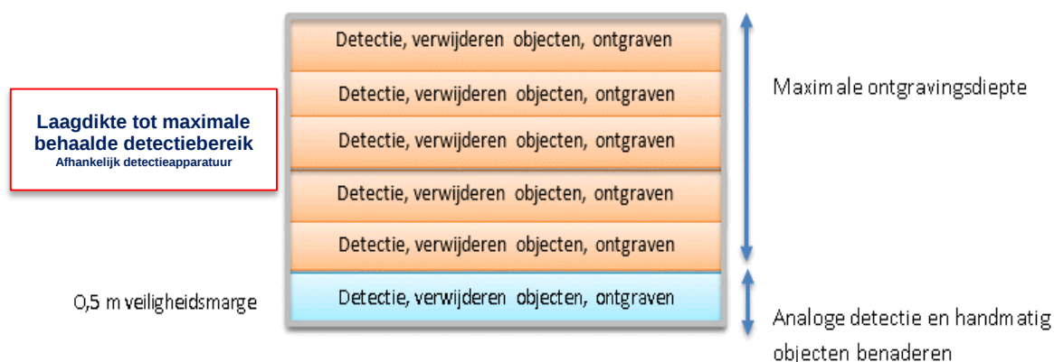
Figuur 34 Schematische weergave werkmethode laagsgewijze oppervlakedetectie
