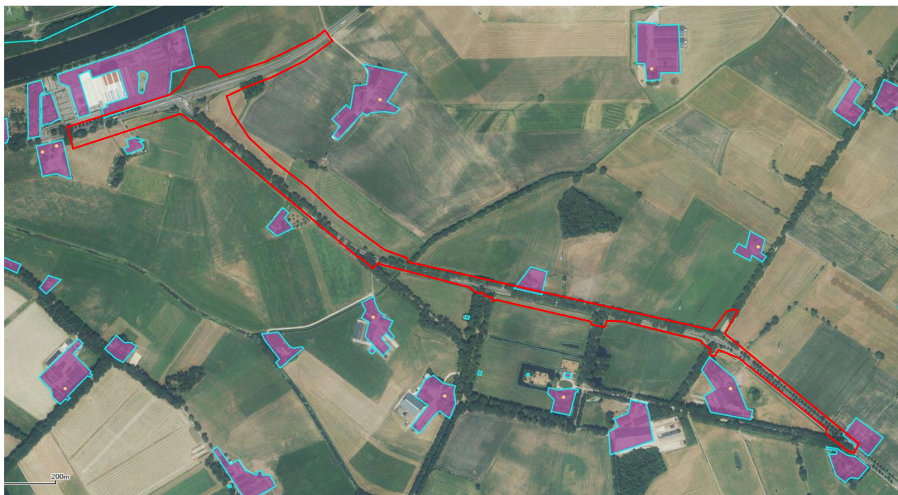
Afbeelding 3: uitsnede uit de asbestkansenkaart van de Provincie Gelderland. De gemarkeerde percelen hebben een verhoogde (grote) kans op aanwezigheid van asbest in de bodem.
