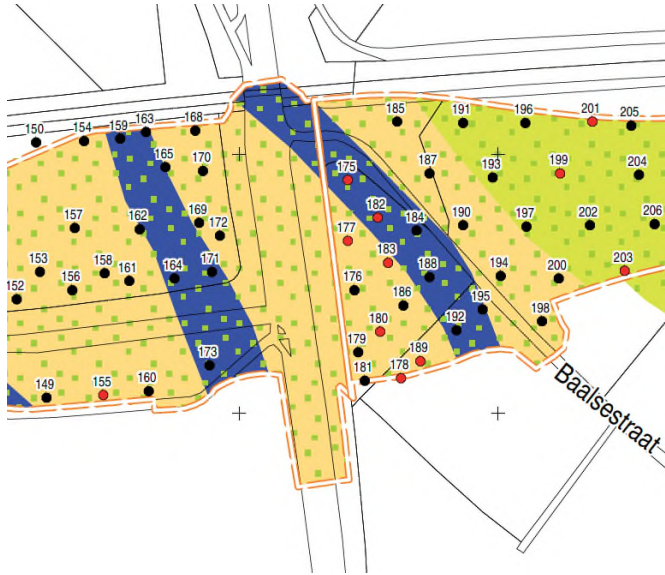
Afbeelding 4: Detail van de resultaten van het booronderzoek uitgevoerd door RAAP. In blauw de kronkelwaardgeulen, in geel de bedding en in groen het pleistoceen terras, overdekt met oeverafzettingen (bron: Goosens et al. 2013, detail figuur VZ2b-4).
