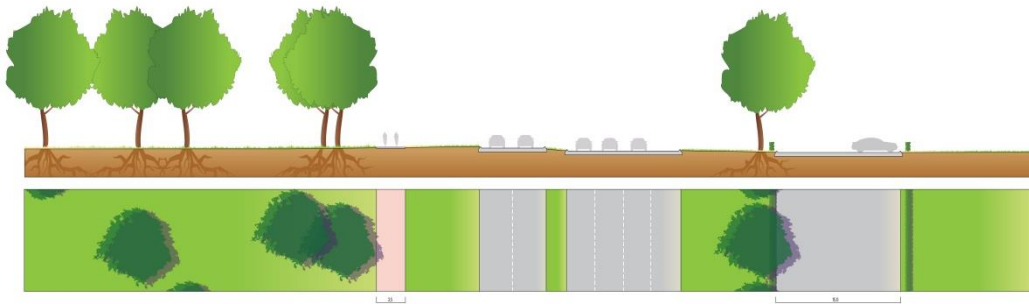
Figuur 7: Dwarsprofiel ten zuiden van de A15 (ter hoogte van de carpoolplaats)
