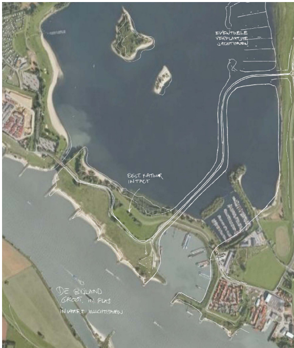
Figuur 4-5: Schetsontwerp grote haven in plas Bijland.
