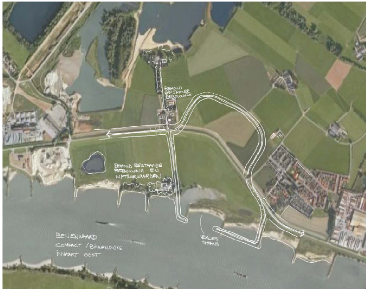
Figuur 4-4: Schetsontwerp kleine haven deels binnendijs Beijenwaard.
