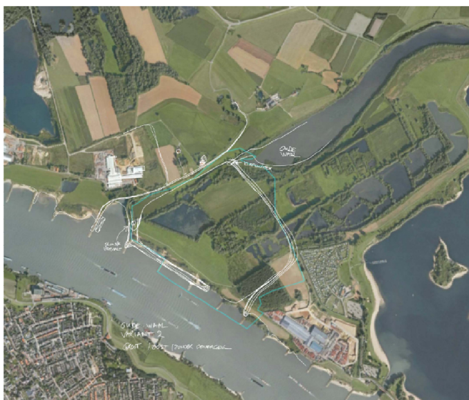
Figuur 4-9: Schetsontwerp grote haven zonder oeversgeul Oude Waal.
