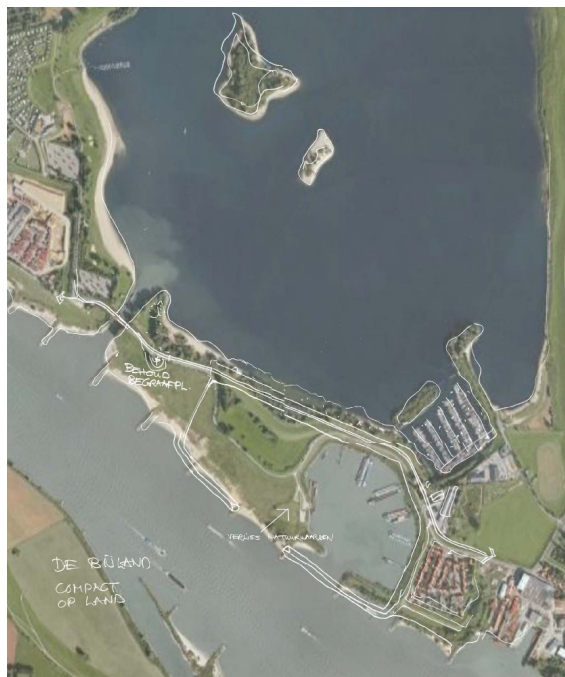
Figuur 4-8: Schetsontwerp kleine haven op land Bijland.
