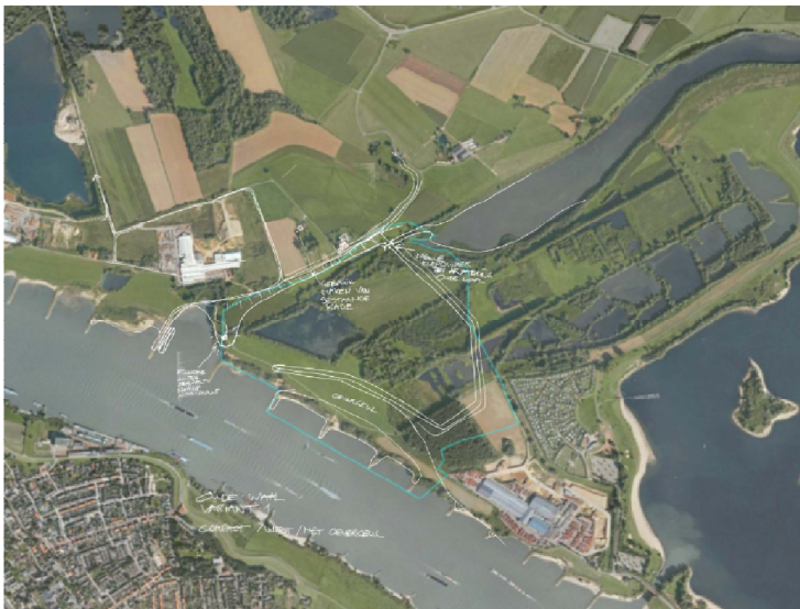
Figuur 4-10: Schetsontwerp kleine haven met oeversgeul Oude Waal.
