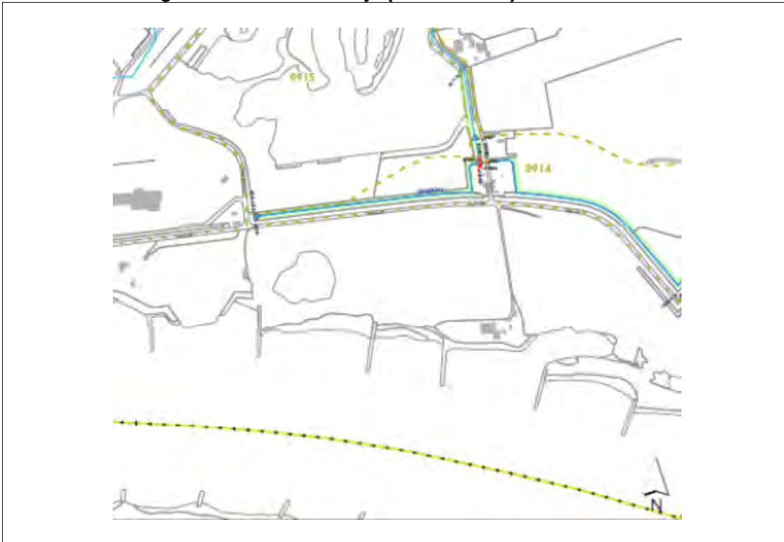
Afbeelding 5.10. Detail leggerkaart waterschap Rijn en IJssel, met de ligging van het grindfilter achter de dijk (in lichtblauw)
