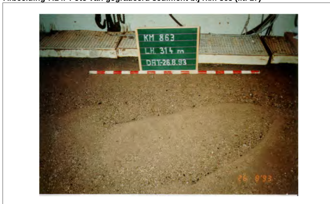
Afbeelding 7.14. Foto van gegradeerd sediment bij rkm 863 (lit. 17)
