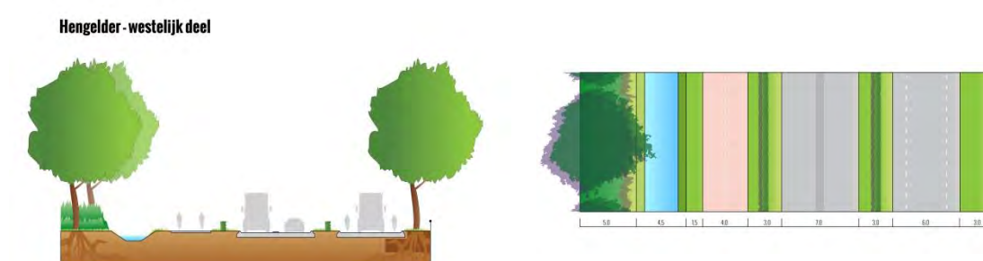
Figuur 16: dwarsdoorsnede en bovenaanzicht Hengelder westelijk deel
