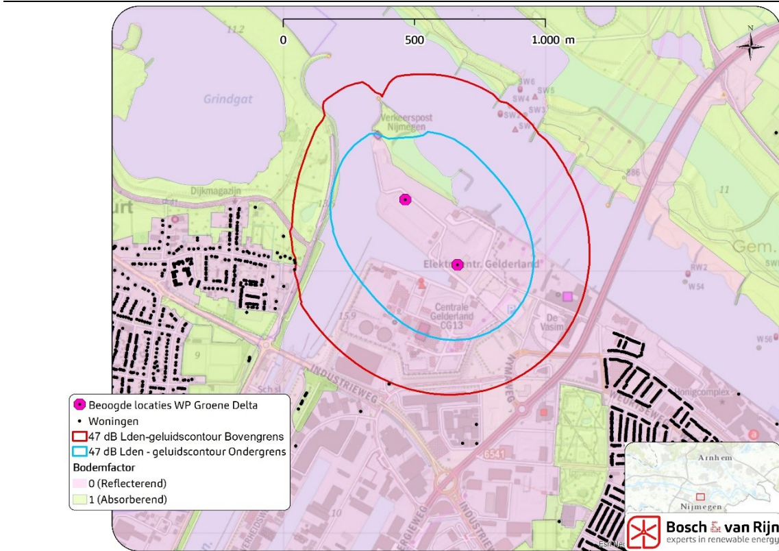
Figuur 10 Geluidemissie van twee onderzochte windturbintypes, die samen de bandbreedte opspannen.
