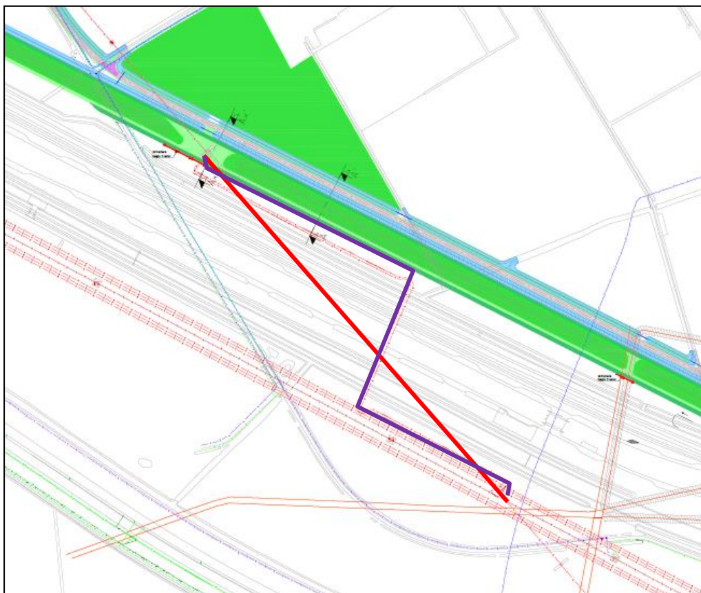
Figuur 40. Schematische weergave verlegging ondergrondse hoogspanningsverbinding ter hoogte van het plangebied. De rode lijn geeft het huidige tracé aan, de paarse lijn het toekomstige tracé. De belemmeringstrook van de nieuwe ondergrondse leiding is maximaal 4,5 m ter weerszijden van het hart van de leiding.
