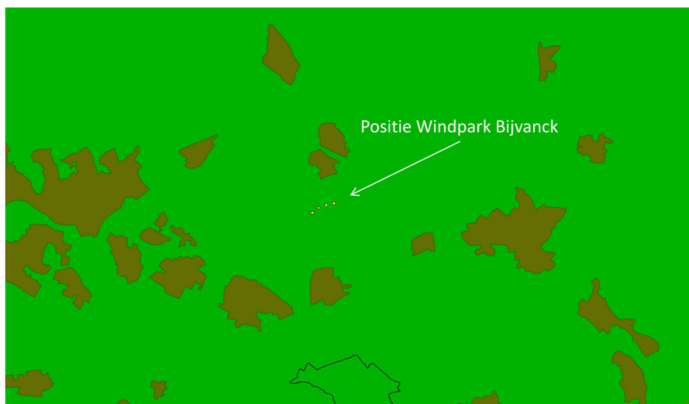
Figuur 6 Detectiekans van het MASS primaire verkeersleidingsradarnetwerk op 1000 voet boven het bouwplan nadat deze is gerealiseerd. De locaties van de windturbines zijn aangegeven met gele stippen. Op dit figuur is detectiekansmiddeling toegepast.
