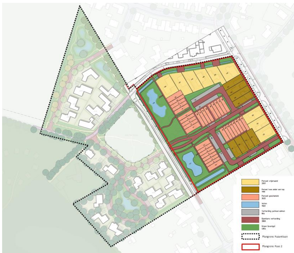
Figuur 6 Bepaling verhard oppervlak op basis van de CAD tekening d.d. 17-10-2024 (bron: Mierlo_Fazantlaan-Oost_VGO_2024-10-17.dwg)
