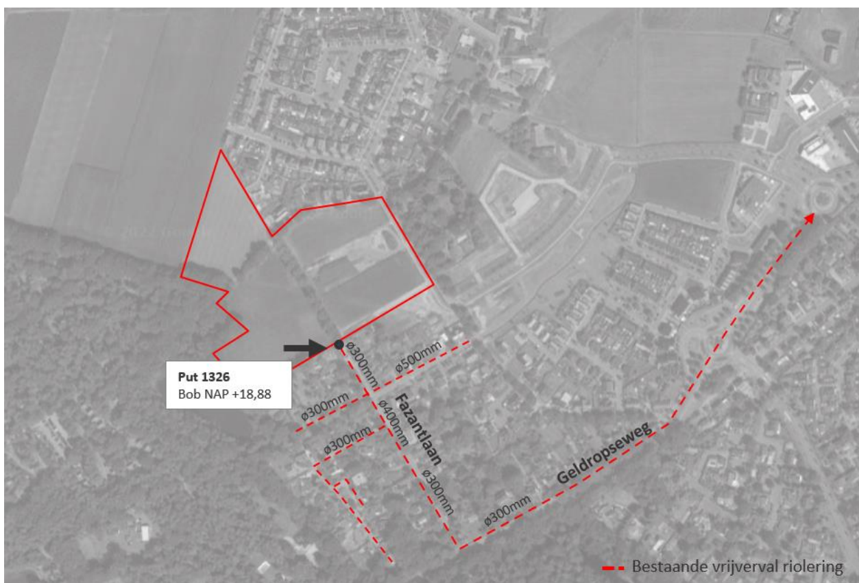
Figuur 4 Bestaande riolering
