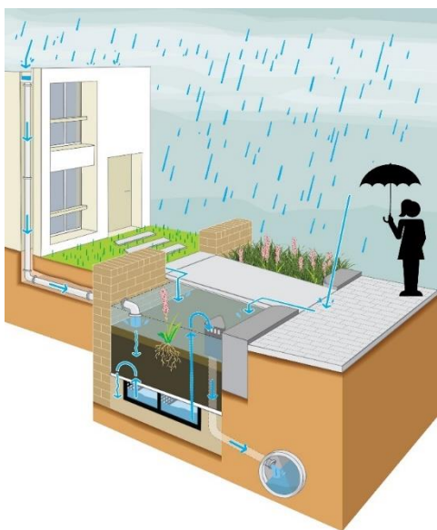
Figuur 9 Principe voorbeeld van een waterbergende groenstrook
