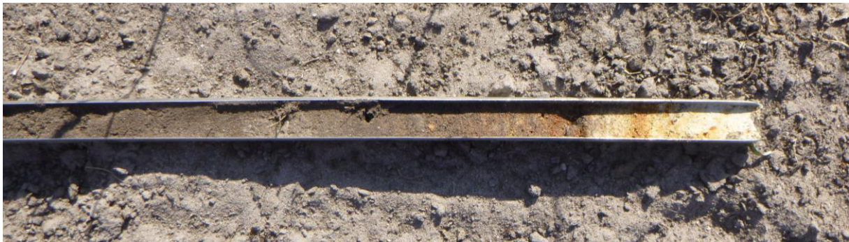
Figuur 23: De op boorpunt 10 direct onder de bouwvoor (links), aangetroffen Cg-horizont (rechts) met geheel rechts nog juist de top van de C-horizont.
