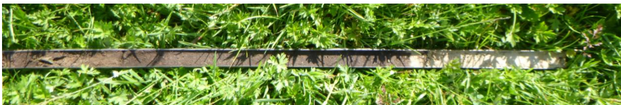
Figuur 22: De bodemopbouw op boorpunt 1 met links de rommelige toplaag van humusrijk zand, in het midden het moerige zand met rechts daarvan de Cg-horizont en geheel rechts het geelgrijze zand van de C-horizont.
