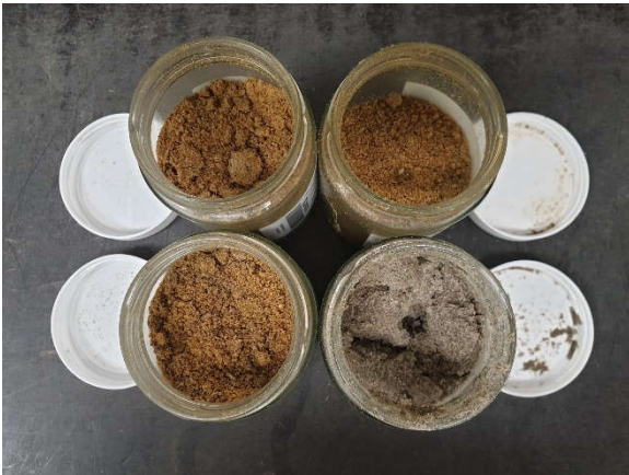
Afbeelding 4.1: Kleurverschil monsters in mengmonster E1
