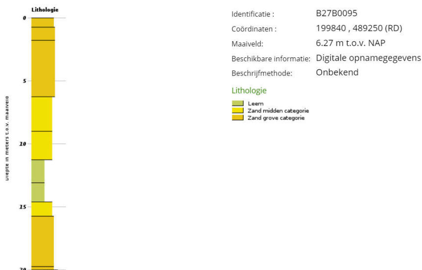
Afbeelding 2.1: Boorbeschrijving boring B27B0095 (bron: Dinoloket)
