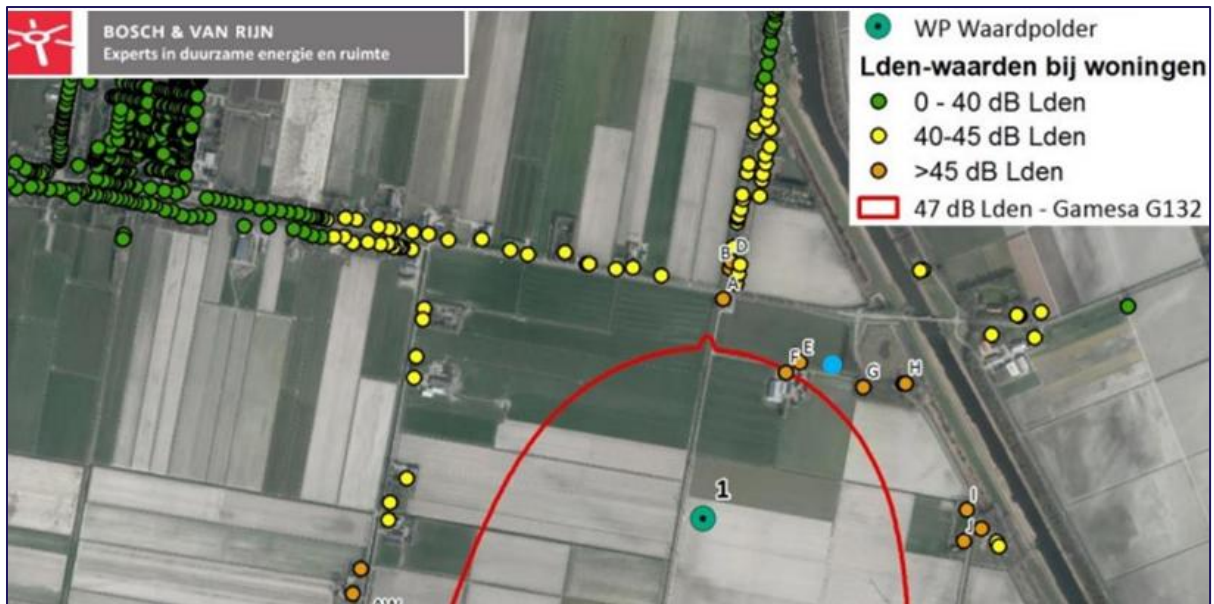
Figuur 18 | Jaargemiddelde geluidsbelasting bij woningen rondom windpark Waardpolder, met de locatie van de nieuwe woning bij de blauwe stip (Bron: Windpark Waardpolder, akoestisch onderzoek – Bosch & van Rijn).
