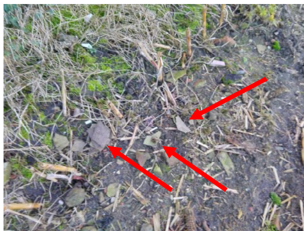
Figuur 7: stukjes asbestverdacht materiaal (M1) op maaiveld
