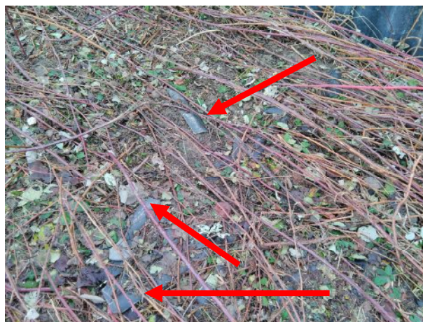
Figuur 9: stukjes asbestverdacht materiaal op maaiveld
