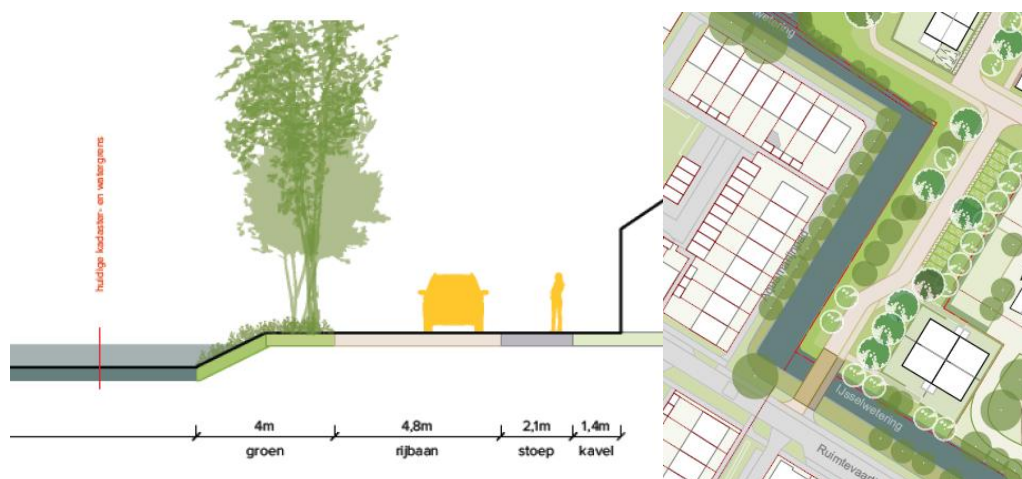
Dwarsprofiel van de westelijke ontsluiting
