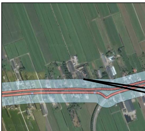
Afbeelding: weergegeven is de legger regionale waterkeringen van het waterschap ter plaatse van het plangebied. Zichtbaar is dat de waterkering langs de Benschopper Wetering en de bijbehorende beschermingszone over het zuidelijke deel van het plangebied lopen.
