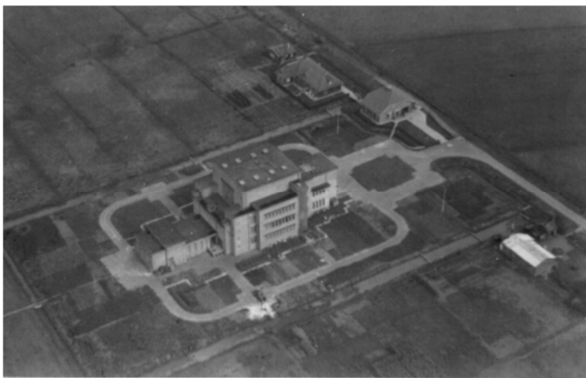
Figuur 4: luchtfoto omstreeks 1943. Goed zichtbaar is de verharding op het terrein en de gegraven U-vormige watergang als koelbassin. Zichtbaar is ook dat het oorspronkelijke slotenpatroon stopt bij de gegraven watergang.
