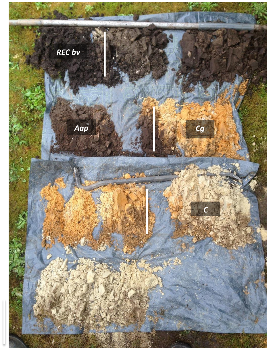
Boring 6: Grotendeels verstoorde bodem. De natuurlijke ondergrond vertoont roestvorming.
