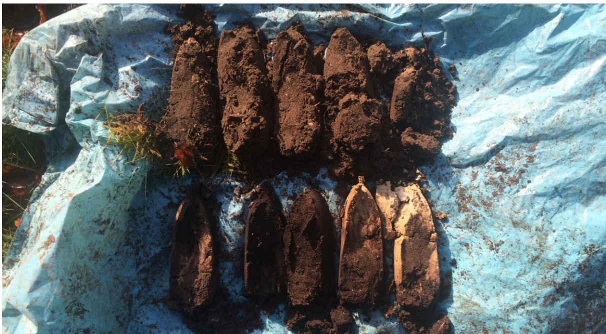
Opname van boring 3. In de top van het pleistocene zand zijn inspoelingslagen (B-horizonten) aanwezig.
