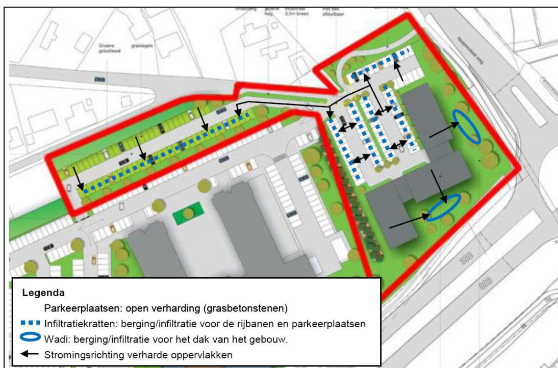
Afbeelding 13: Opzet globale hemelwaterbehandeling Multizorgcentrum (ondergrond is Inrichtingsplan d.d. 12 september 2014).
