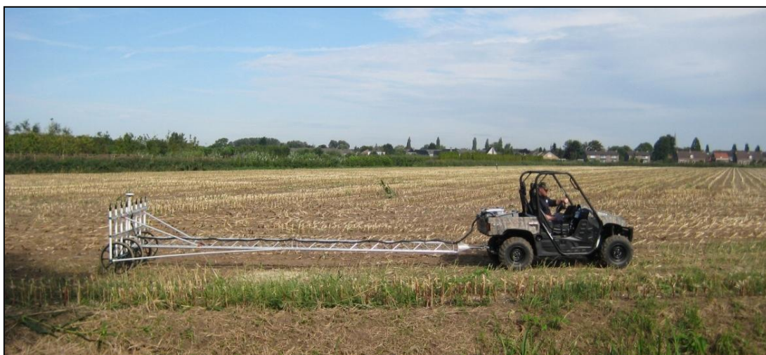
Afb.1 - Multisensorsysteem door een voertuig voortgetrokken.
