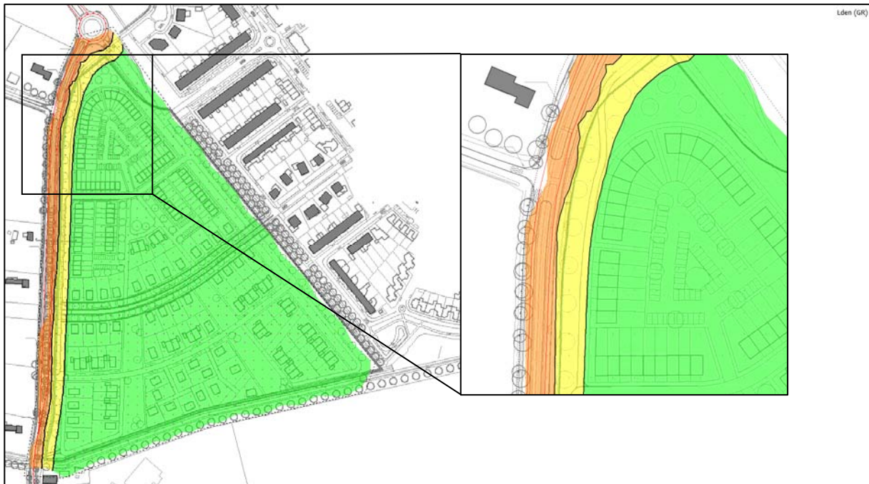
Figuur 5: geluidcontouren op 7,5 meter hoogte: Ruitersweg (dunne deklaag type B)
