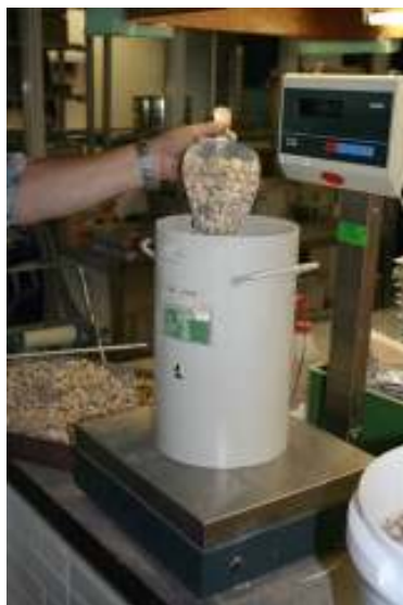
figuur 3 Bepaling stordichtheid grind
