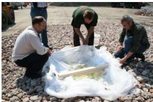
figuur 7 Kornvormig gat afgedekt met folie, gevuld met water
