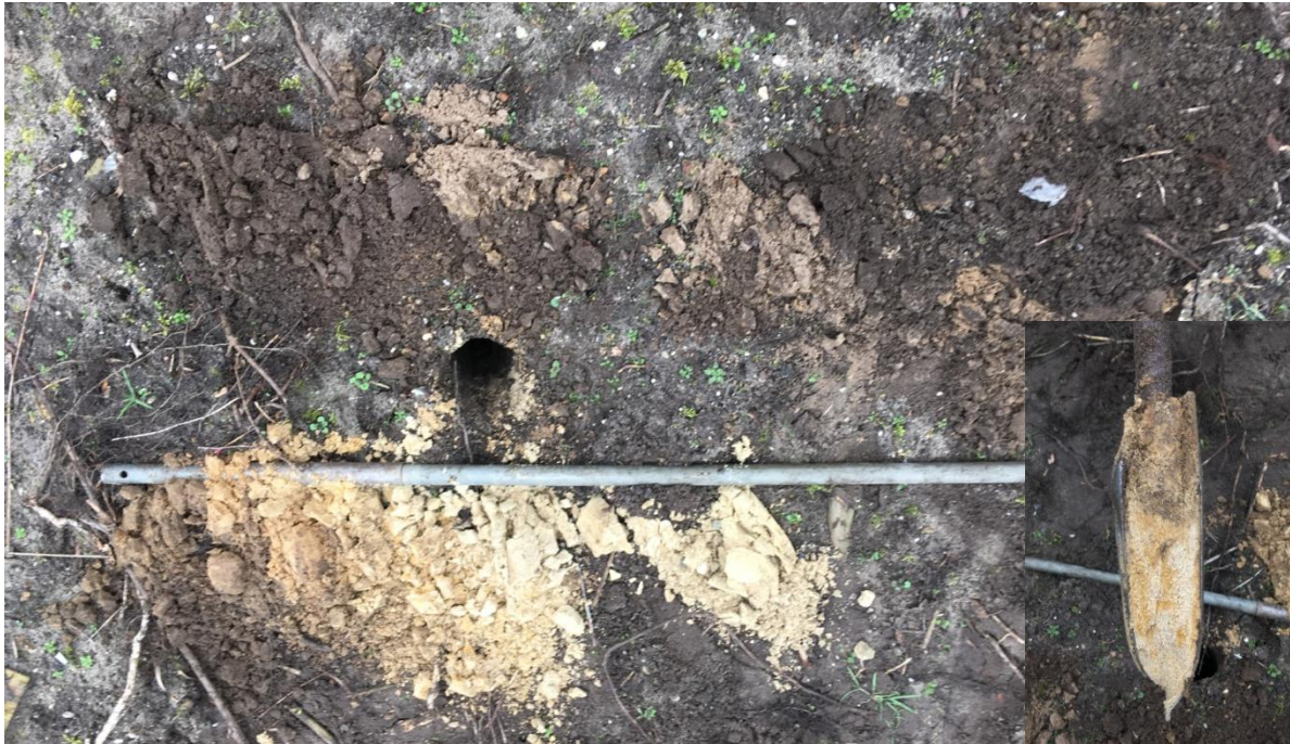
Boring 3. De top van het profiel ligt linksboven in de hoek en de C-horizont rechtsonder in de hoek. Het profiel in de boorkop, rechtsonder, laat een scherpe overgang zien.
