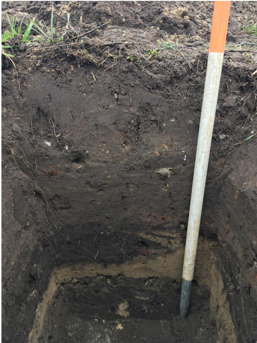
Profielputje (boring 7). De verstoorde toplaag met beton- en baksteenfragmenten op een laag bouwzand. De diepste laag van het profielputje is eveneens verstoord en bevat baksteenfragmenten.
