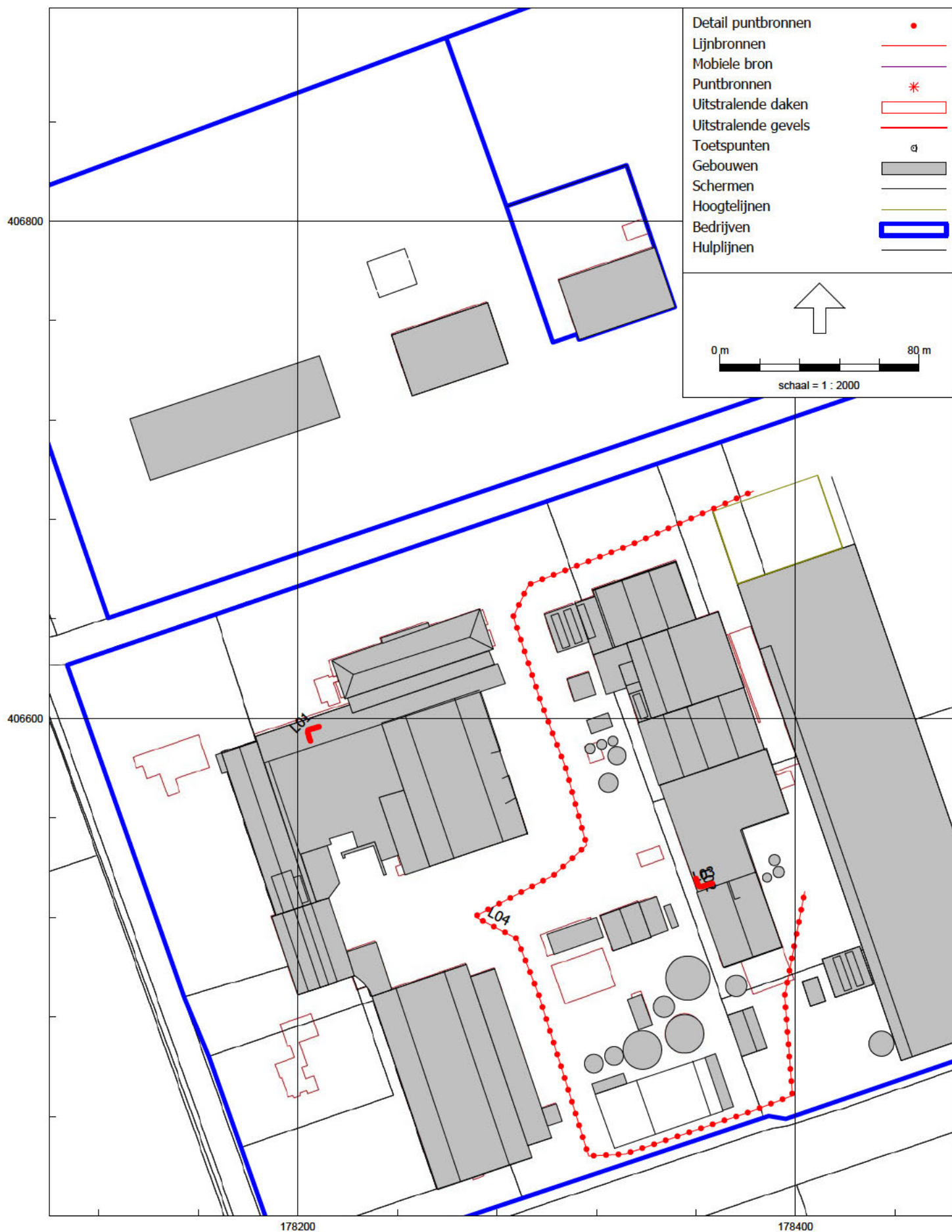
figuur 5g: Overzicht rekenmodel met positie geluidbronnen
