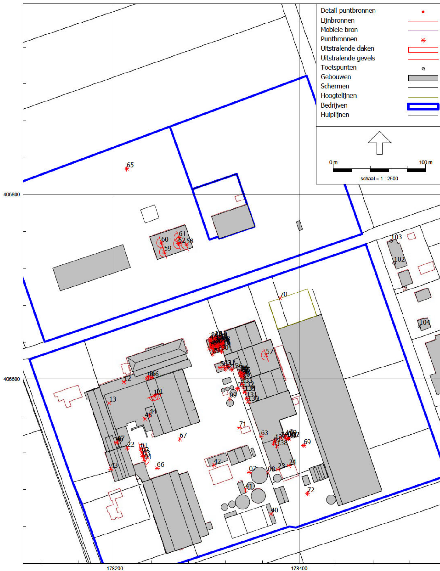
figuur 5e: Overzicht rekenmodel met positie geluidbronnen
