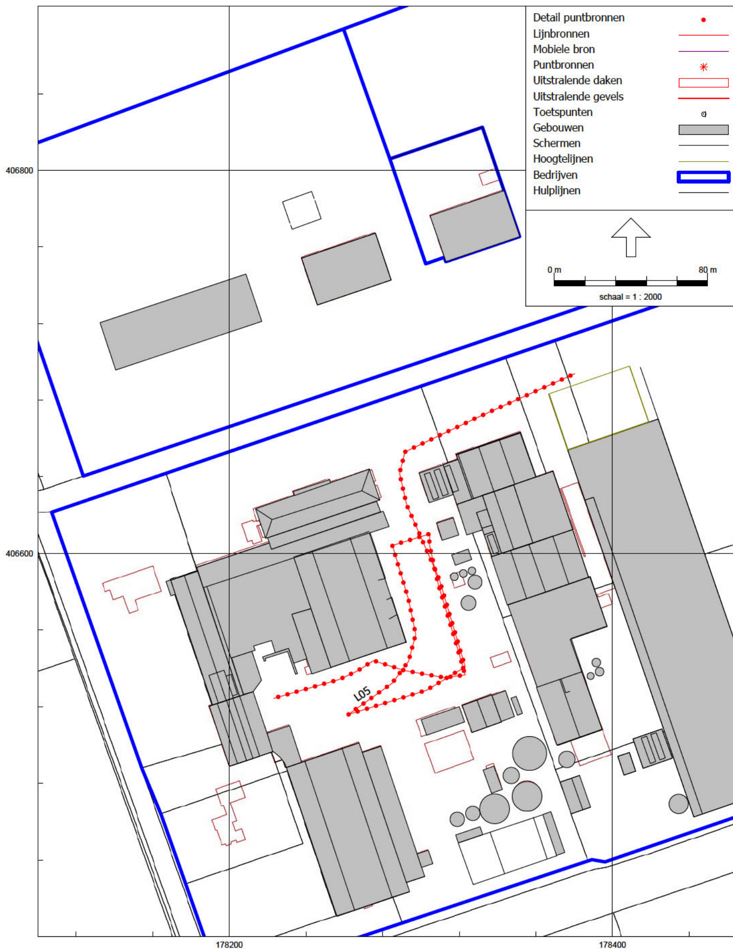
figuur 5h: Overzicht rekenmodel met positie geluidbronnen
