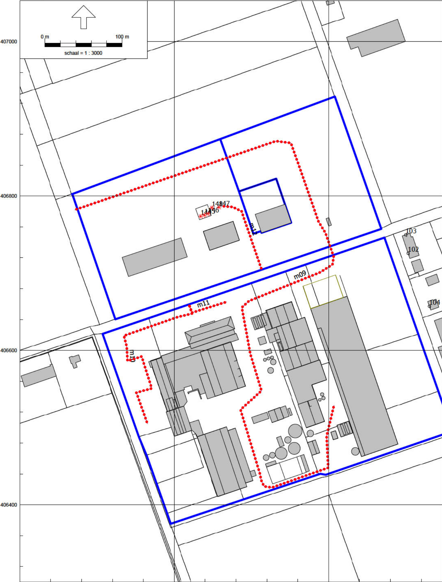
figuur 5i: Overzicht rekenmodel met positie geluidbronnen - rijroutes -
