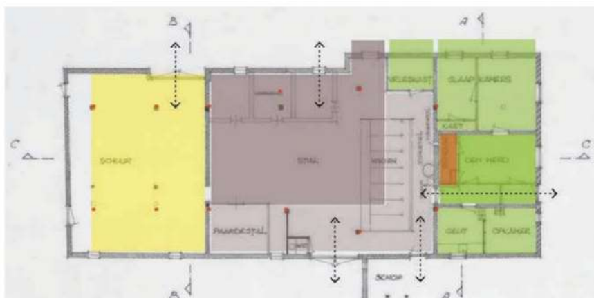
Ordering / hoofdopzet van de boerderij in resp. de perioden pré 1830, 1830 en 1860 getekend over de huidige plattegrond. In groen de woonruimtes, rood de haard en gebintstijlen, bruin de stal/posstal en de 'deel' en lasruimtes in geel.
