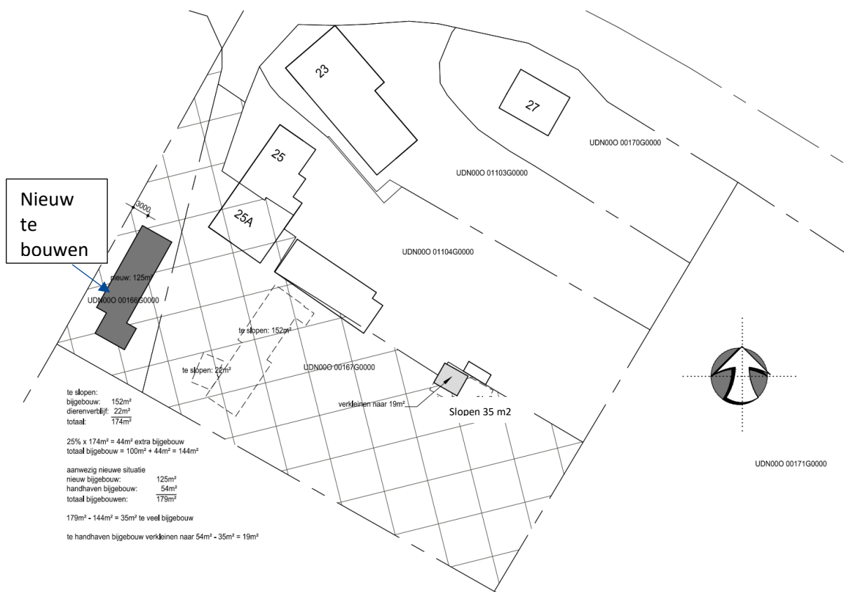
Figuur 1.4: overzicht bebouwing totaal gesloopt ca. 200 m²
